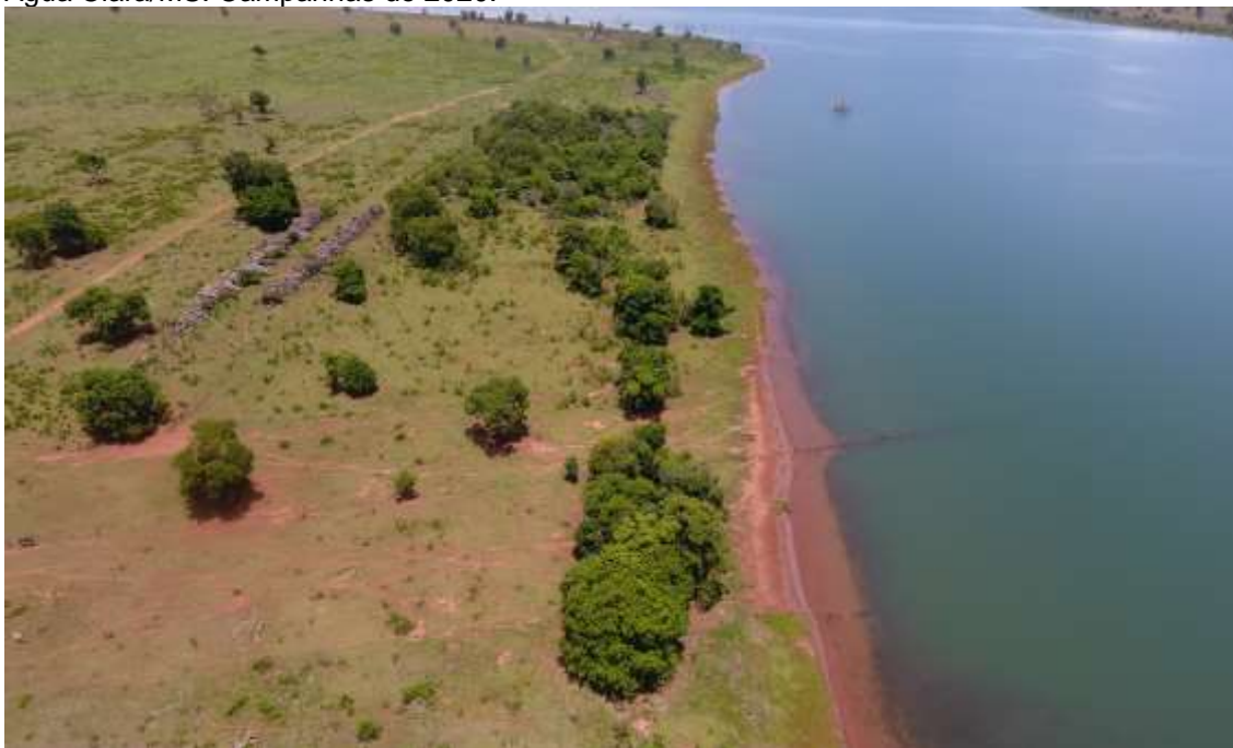
Figura 7 – Ponto 3. Erosão laminar na margem do reservatório, área 1 da PCH Verde 4, município de Água Clara/MS. Campanhas de 2020.
