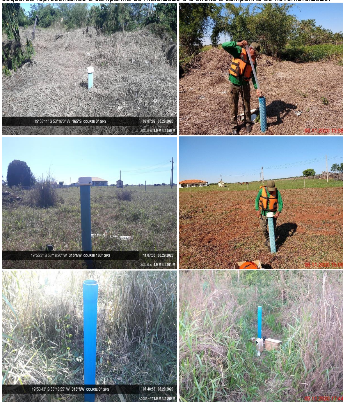
Figura 2 - Poços de monitoramento da PCH Verde 4. Pontos de cima para baixo: P1 a P6. Figuras a esquerda representando a campanha de maio/2020 e a direita a campanha de novembro/2020.
